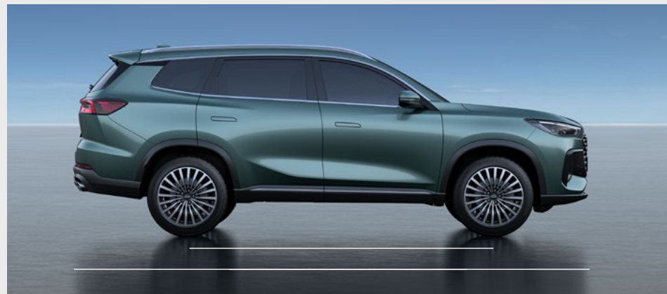
Długość całkowita: 4725 mm, rozstaw osi: 2710 mm
